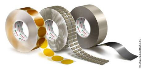
**Bild 4** Tapes gibt es sowohl als elektrisch leitfähige Lösungen wie metallisierte Gewebe- oder Schaumträger mit elektrisch leitfähigem Acrylatklebstoff als auch als elektrische Isolationslösungen wie einseitig klebende PET-Folien in verschiedenen Dicken und Farben.
